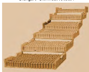
手工锤子压制后高频瓷绝缘子的干化（私人收藏）
